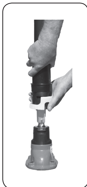
Når den ønskede højde er fundet drejes spindelforlæn-ger ¼ omgang hvorved den fastlåses i positionen
